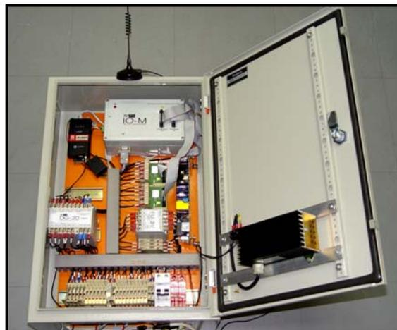
Figura 6: Unidade de coleta, comunicação e transmissão de dados com condicionamento de sinal.
