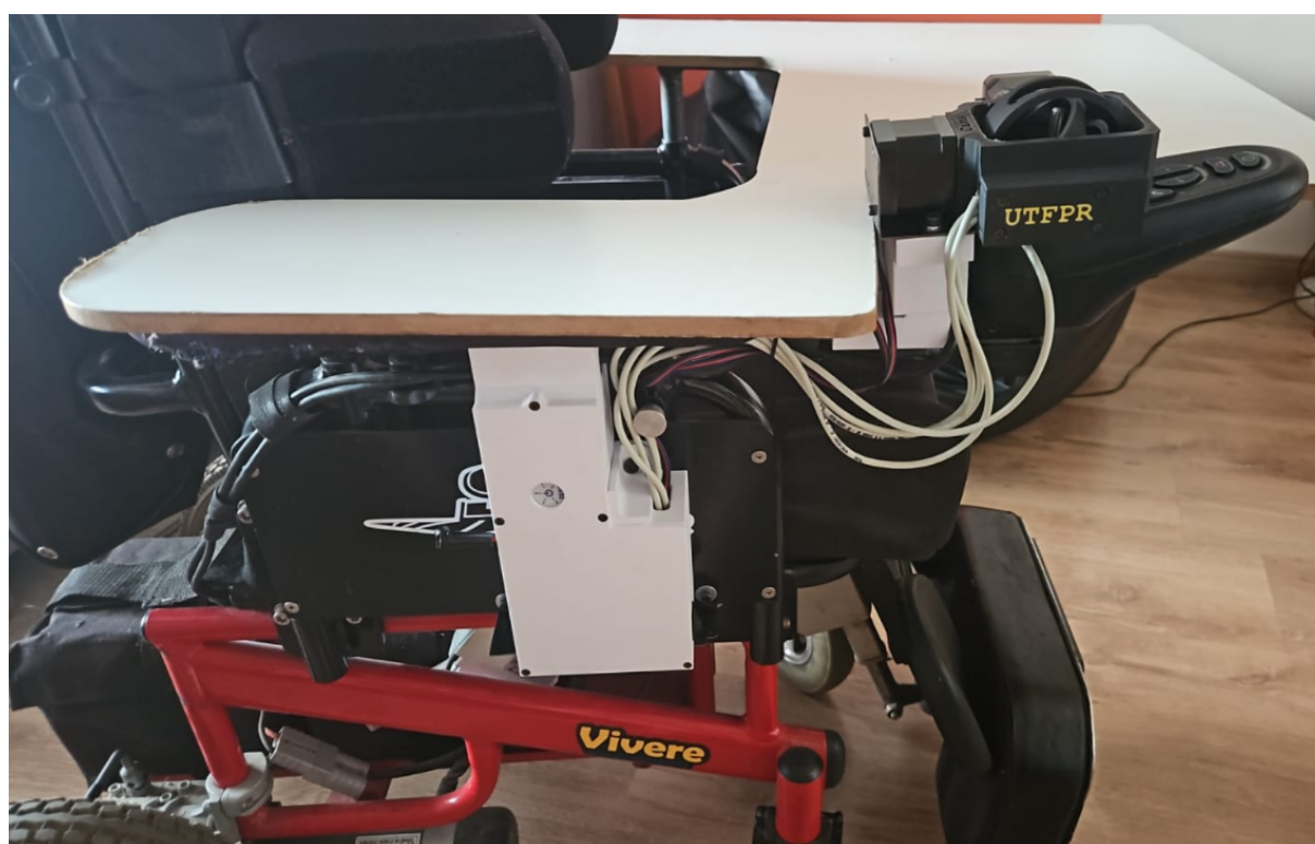
Figura 12 - Sistema montado na cadeira de rodas após impressão 3D e montagem dos componentes.
