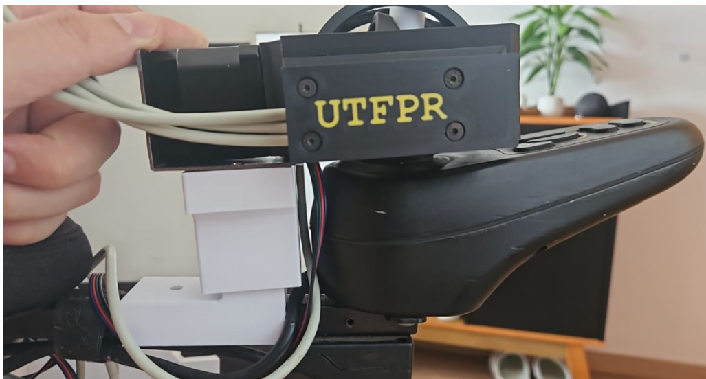
Figura 8 - Encaixe entre o dispositivo acoplável, o suporte de fixação e a haste adaptada.
