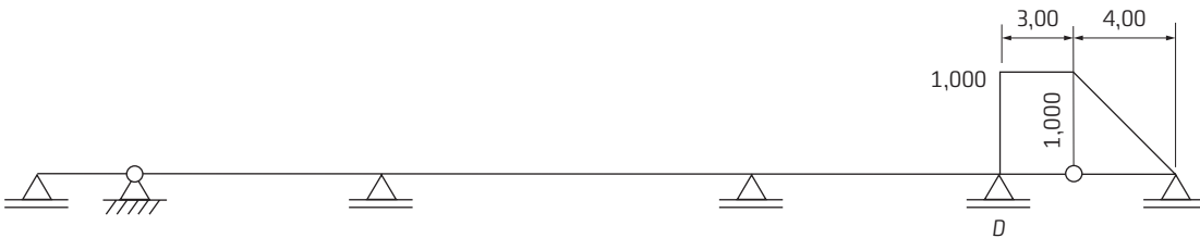
Fig. 9.98 Linha de influência de cortantes à direita do apoio D ( L.I.V_D^{dir} )
