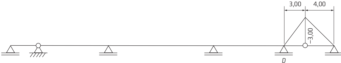
Fig. 9.97 Linha de influência de momentos fletores no apoio D ( L.I.M_D )
