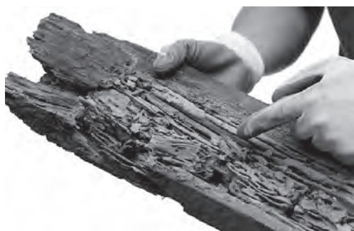
Fig. 4.13 Aspecto laminado da madeira com presença de restos de terra nos canais
