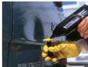
2. Lixar o conector com a manta abrasiva e retirar os resíduos. Com o auxílio do aplicador de cola, aplicar um certa quantidade sobre o conector.
