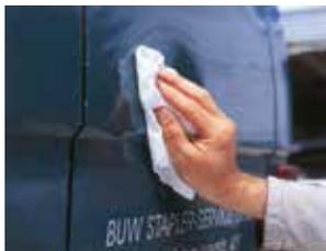
1. Limpar a área a ser reparada com um desengraxante. Em carros repintados, verificar se a pintura não está trincada e se a tinta não sai no pano.
