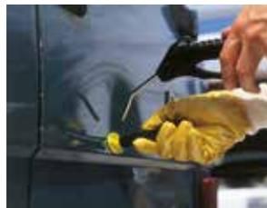
3. Posicionar o conector no ponto mais profundo do amassado, se necessário fazer uma marcação em formato + (cruz). Aguardar alguns minutos até resfriar a cola. Para acelerar o processo, utilizar ar comprimido.
