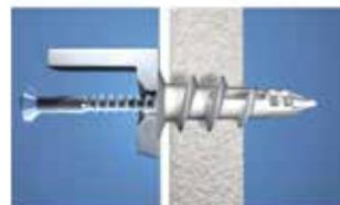
3 - Inserir o parafuso, para finalizar a fixação.
