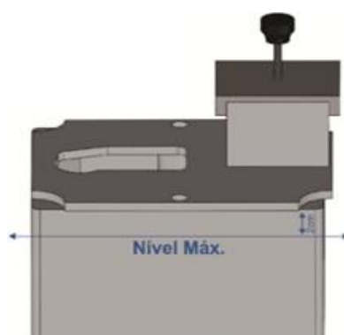
Figura 22 - Reservatório de cola
